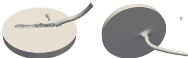
Рис. 2. Конфигурации ударника и преграды после их взаимодействия. v_0 = 250 м/с, \alpha = 50^\circ . Слева – \beta = 0^\circ , справа – \beta = 10^\circ .
