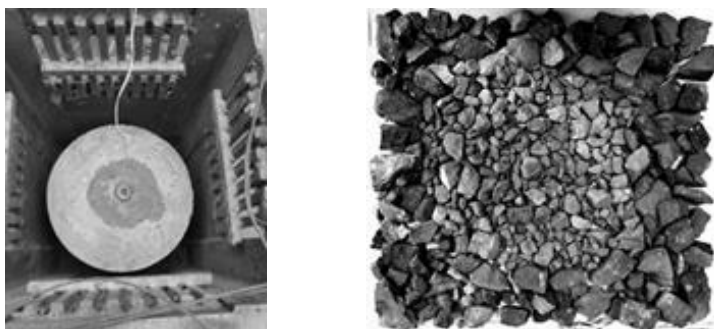
Рис. 1. Композиционная модель внутри испытательного стенда (слева) и фрагменты разрушенной части имитационной модели (справа).
