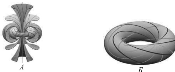
Рис. 6. А – разбиение 3-мерного евклидова пространства на попарно зацепленные окружности и прямую; это стереографическая проекция сферы S^3 из 4-мерного пространства в 3-мерное евклидово пространство [15,25]; Б – окружности Вилларсо: два семейства окружностей, возникающих при сечении тора дважды касающейся его плоскостью [25].
