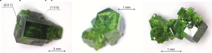
Рис. 1 Выращенные из раствора-расплава на основе Bi_2O_3-Na_2O кристаллы хантита GdFe_3(BO_3)_4 .
