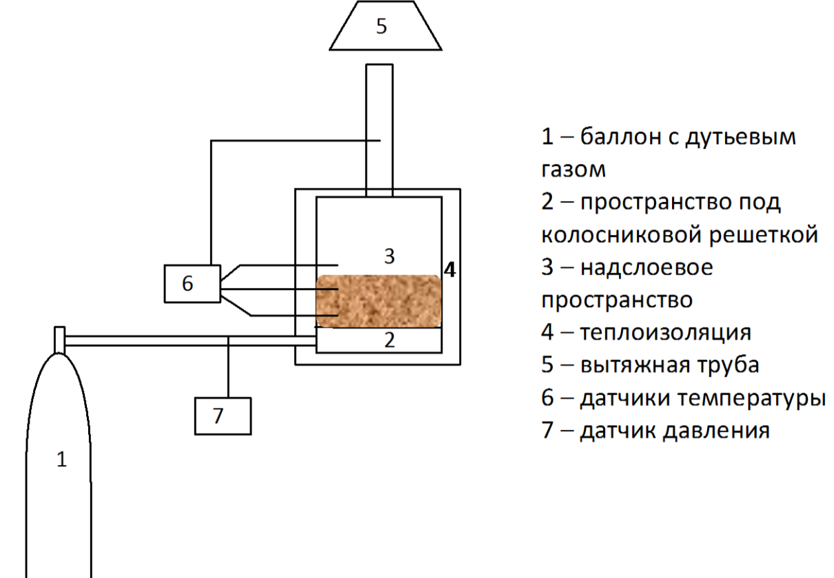
Внешний вид экспериментальной установки
