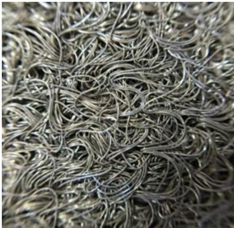
Фехраль (X23Ю5Т). Содержание Cr - 22-24%, Al - не более 5-5,8%, Ni - до 0,6%, Ti - 0,2-0,5%, Fe – ост.
